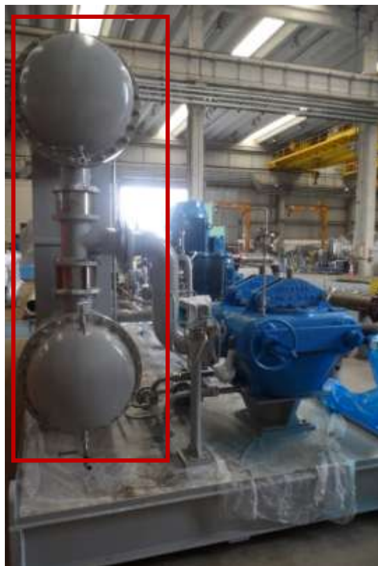
Figura 6 – Vaso de pressão de sistema de lubrificação de turbinas a vapor, fornecido com skid independente
